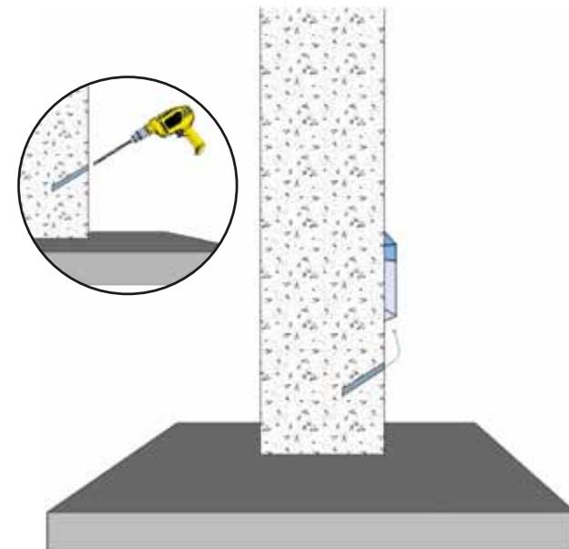
Es necesario que el contenido de las inyecciones vacíe totalmente, dependiendo de la saturación de humedad puede tardar varios días, en casos de gran humedad puede ser necesario hacer agujeros drenantes en la base.
