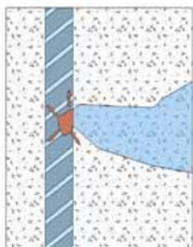
3. El volumen de la armadura con corrosión es considerablemente superior al volumen inicial, esta expansión provoca roturas del hormigón y pérdida de sección de la armadura, lo que se traduce en una pérdida de adherencia armadura-hormigón, con la caída de resistencia correspondiente.
