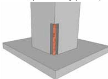
Una vez saneada la zona se termina la reparación aplicando **Moris inhibidor**, mortero de reparación con inhibidor de corrosión incorporado, que recompone la sección y protege las armaduras.
