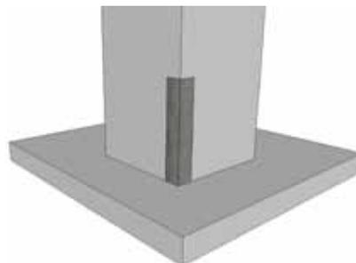
Antes de la aplicación de los inyectores se recomienda esperar un mínimo de 8 días para asegurar un buen curado de la reparación.
