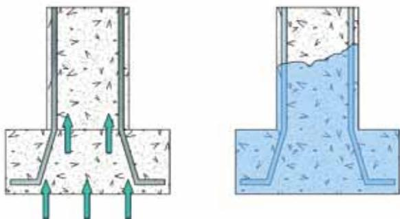
2. La combinación de estos elementos con el hormigón provocan una caída del PH, dejando desprotegidas las armaduras y facilitando el inicio de un proceso de corrosión.
